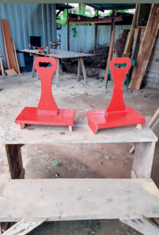
DIE NEUEN LATRINENDECKEL
